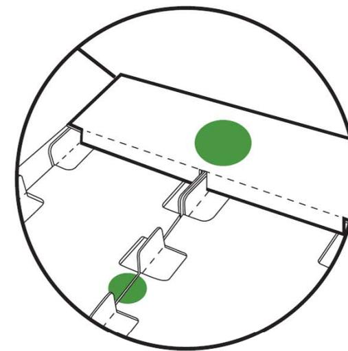
Dettaglio del corretto posizionamento delle protezioni interne superiori e dell'uso corretto delle falde per bloccare le protezioni tramite le alette.
